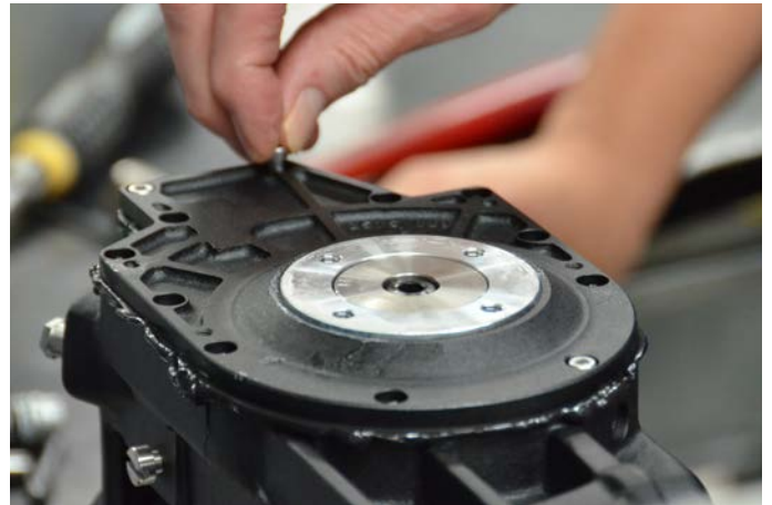
11. ベース部に、気密シールと共にカバーを取付
