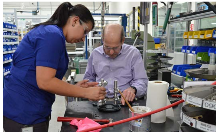
12. ヘッドのチルトアセンブリの上部に、アッパーウィップルツリーシャフトを取付ける。
