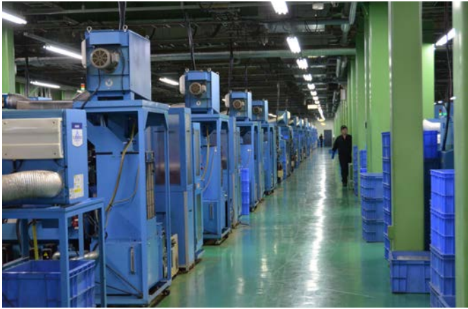
ずらりと並ぶ自動工作機械、これらによってレンズ鏡筒などの部品を切削する。
