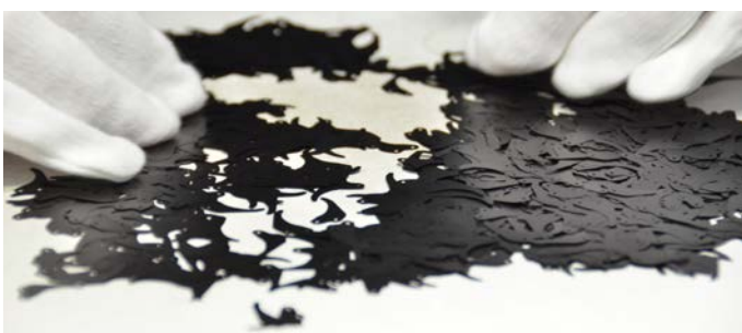
絞り羽根は切り抜かれアルマイト処理された後、組立てられる。
