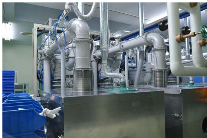
大型の真空蒸着器により、反射防止コートを施し、コントラストの向上や光量確保、フレア、ゴーストの削減ができる。
