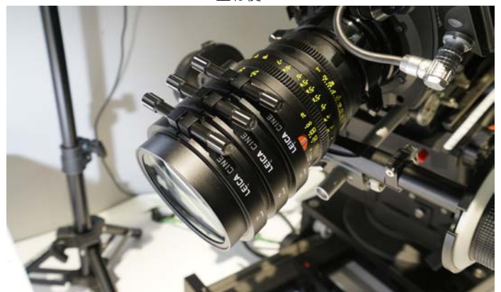
写真のようにマクロルクス+1を3枚重ねて+3にした場合も画の品質は保持される。
