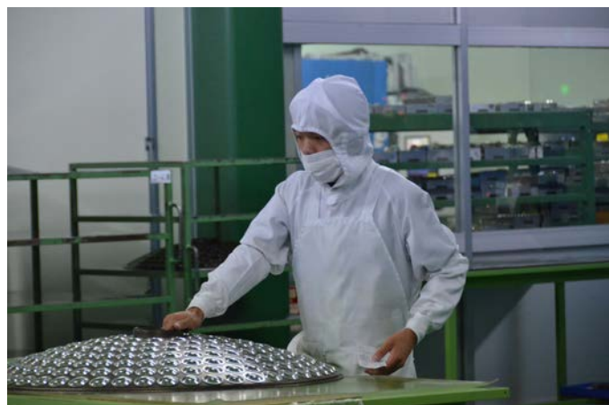
大きなトレーにレンズを設置しコーティングの準備をしている。
