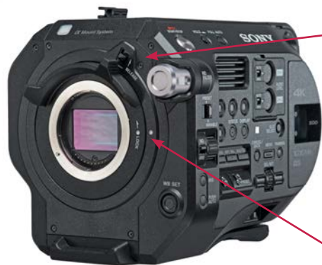
レバーロック式Eマウントにレンズを装着するには、まず指標となる白点を合わせる。
