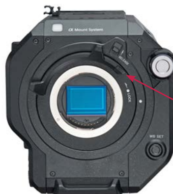
レバーを反時計回りに回してロックする。
